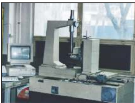
Fig.2 Sistem inteligent pentru controlul indicilor de precizie ai roților dințate
